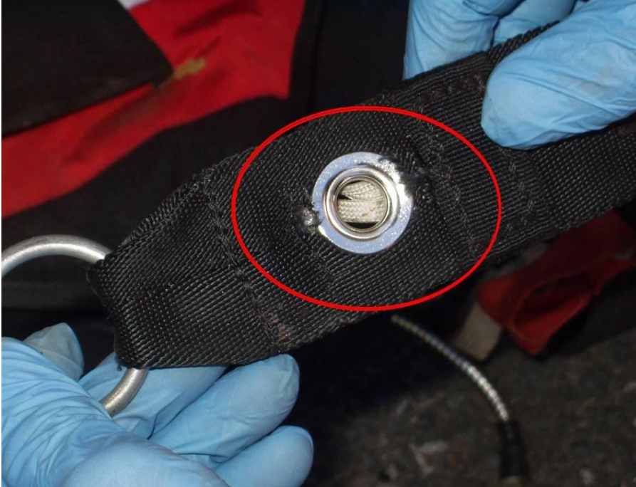
8. ábra Rojtosodás a hevederen található ringli körül
