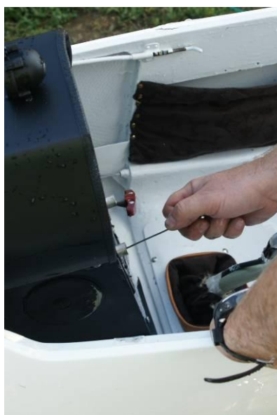
13. ábra Az esetben érintett vitorlázó repülőgép vizsgált kioldó szerkezete
