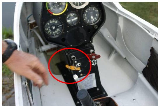
12. ábra A kioldó fogantyú a kabinban
