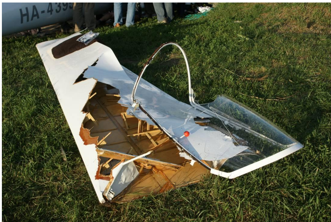
9.ábra A szárny összeroncsolódott bal oldali külső része (füle)
