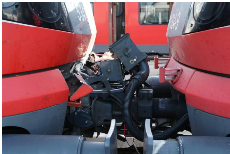
3. ábra Az összekapcsolódott és megrongálódott kapcsolófejek
