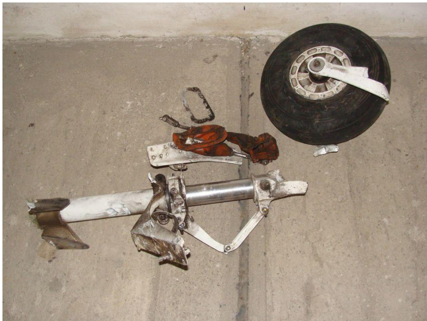
6. sz. ábra: Az orrfutó maradványain anyagfáradásra utaló jelek nem voltak felfedezhetőek.
