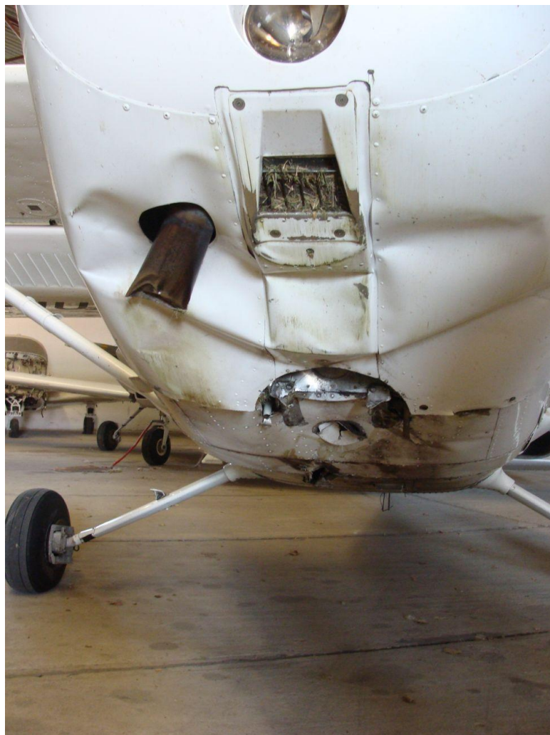
8. sz. ábra: A repülőgép törzs orr rész alsó része horpadásos sérüléseket szenvedett
