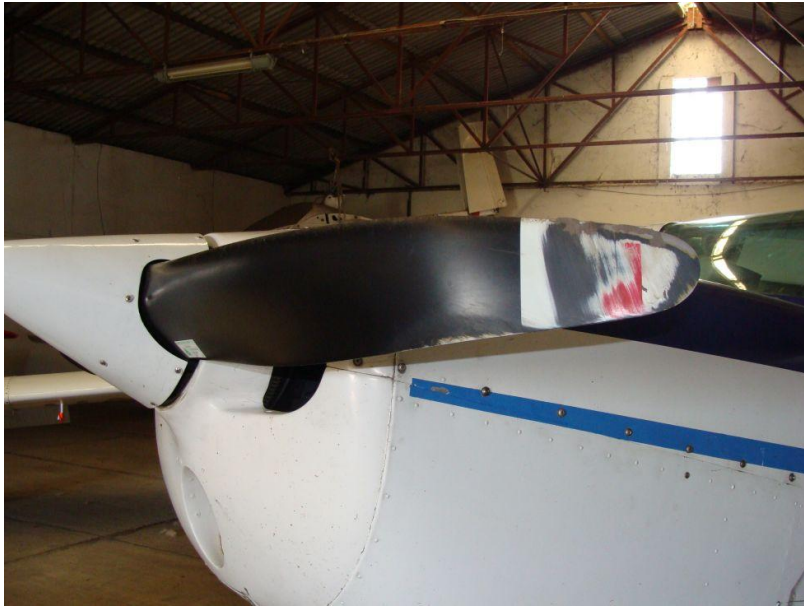
7. sz. ábra: A légcsavarvégek a repülési iránnyal ellentétesen elhajlottak
