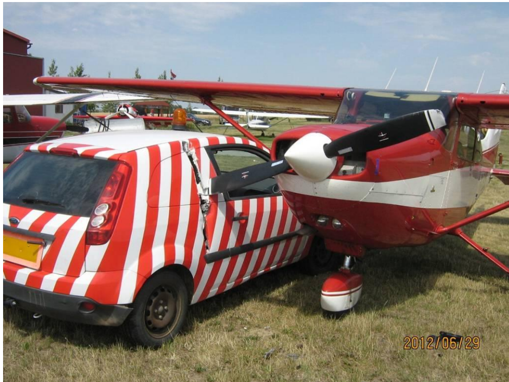
5. kép. A légcsvár és a gépkocsi sérülései.
