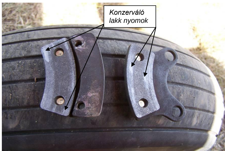
7. kép. Fékbetéteken a féktárcsával érintkező felület nyoma. (KBSZ fotó)
