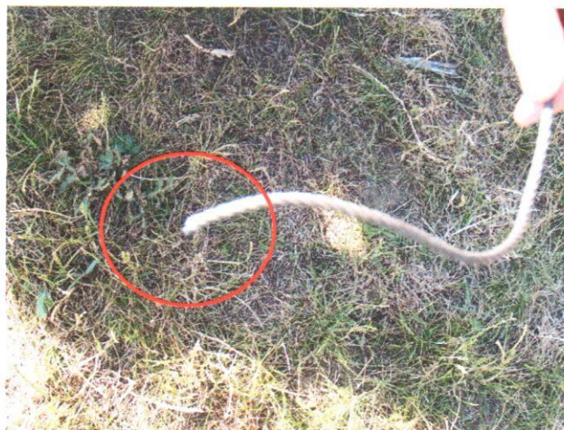
2. ábra Elvágott csörlőkötél vég
