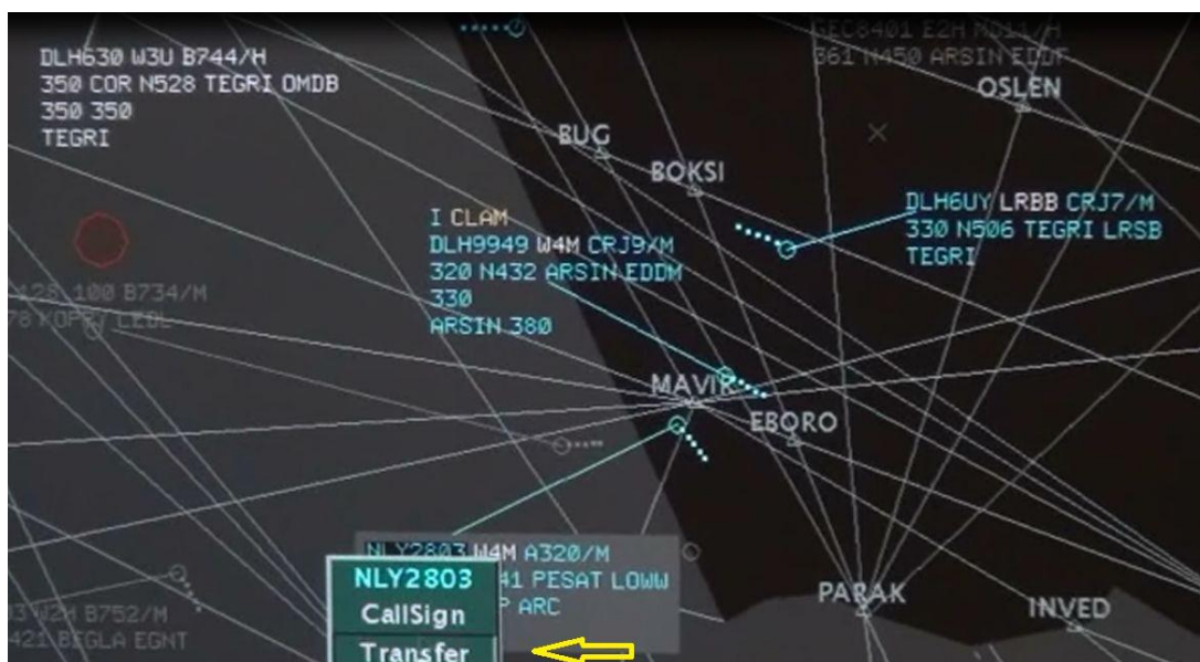
EL EC képernyő: az EL EC a „Transfer” funkció alkalmazásával elindítja a NLY2803 járat irányítás átadás-átvétel folyamatát
