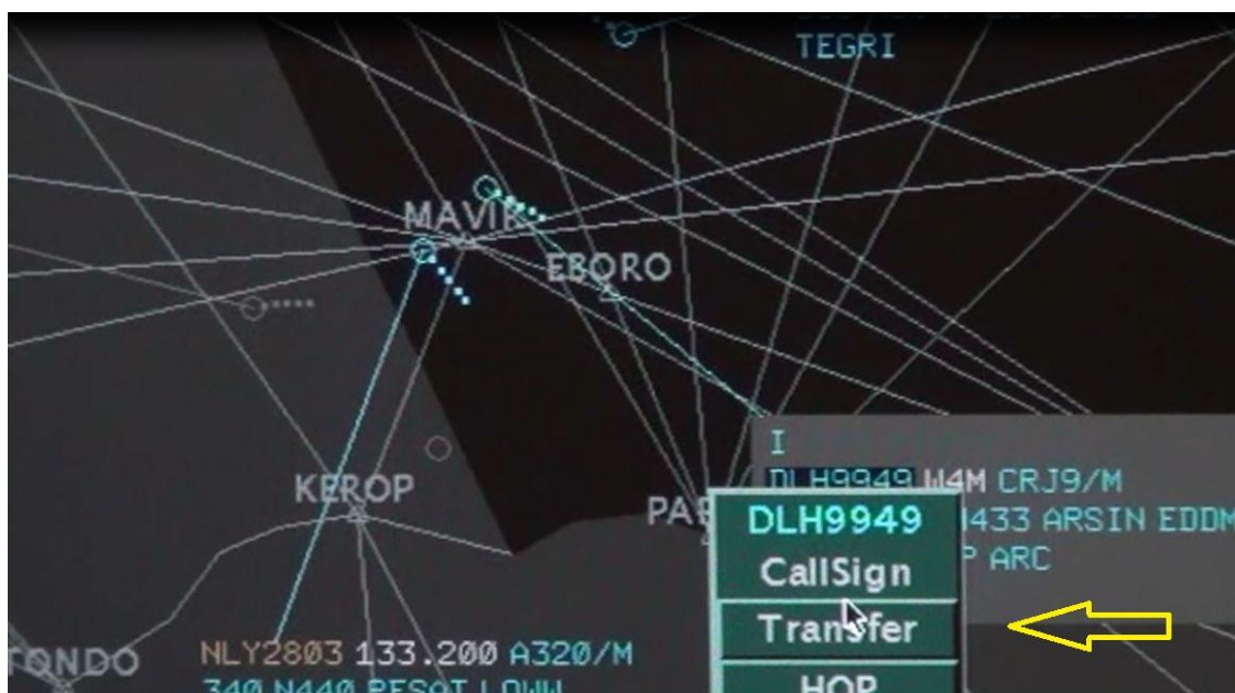
EL EC képernyő: az EL EC a „Transfer” funkció alkalmazásával elindítja a DLH9949 járat irányítás átadás-átvétel folyamatát
