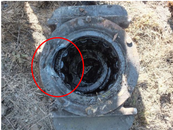
10. sz. ábra A tengelyvég nyoma a csapágyházon
