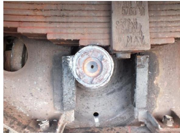
11. sz. ábra A tengelyvégre felfekvő laprugóköteg
