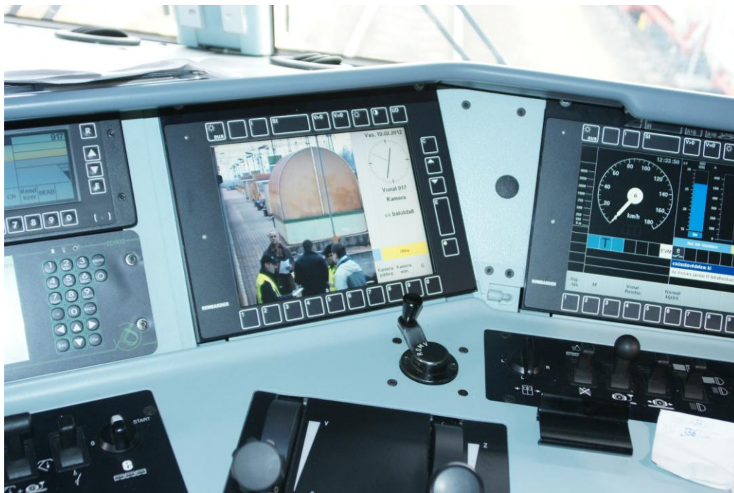
6.sz.ábra: a mozdony vezetőállásán a diagnosztikai képernyő
