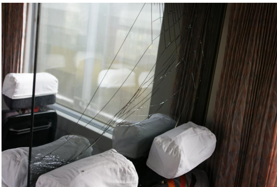
4.sz.ábra: a megrepedt üveg válaszfal
