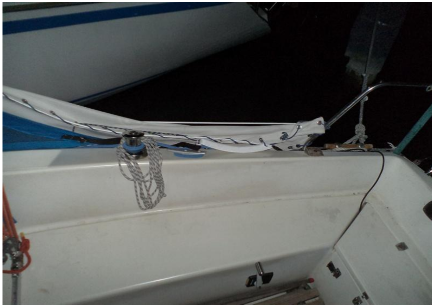
3. ábra: a leszakadt fedélzeti korlát
