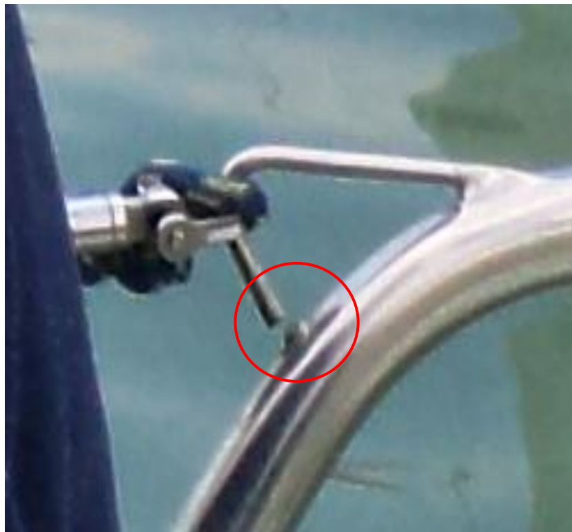
9. ábra: a törött szár 2012. szeptemberében
