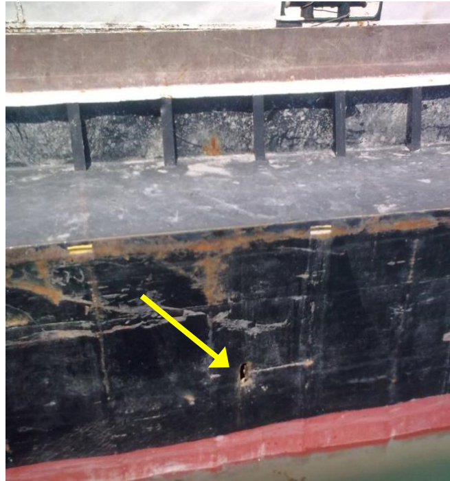
6. ábra: A sérülés elhelyezkedése a kiemelt, üres uszály jobb oldalán
