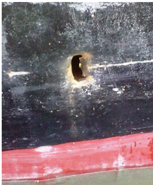
A lék mérete, formája és elhelyezkedése alapján, a Vb feltételezése szerint az uszály testének lékesedését az „IZSÓ” vontató farával történt ütközés során, a vontató merevítő bordája okozhatta.
