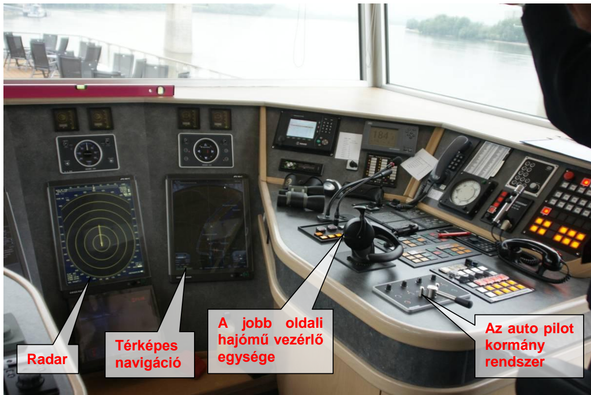
13. sz. ábra: A kormányállásban elhelyezett műszerek, berendezések, kapcsolók, megjelenítők, funkcionális vezérlő egységek.
