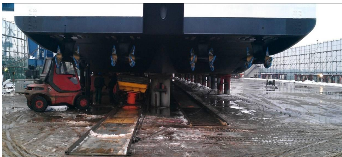
12. sz. ábra: A propulziós hajtások a hajó far részén, ké-két egység a jobb és a bal oldalon
