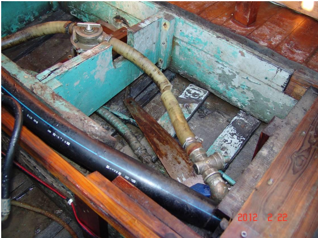
4. sz. ábra: A második szemlén bemutatott, elvágott hűtővízcső a hajófenékben levő fűrésszel
