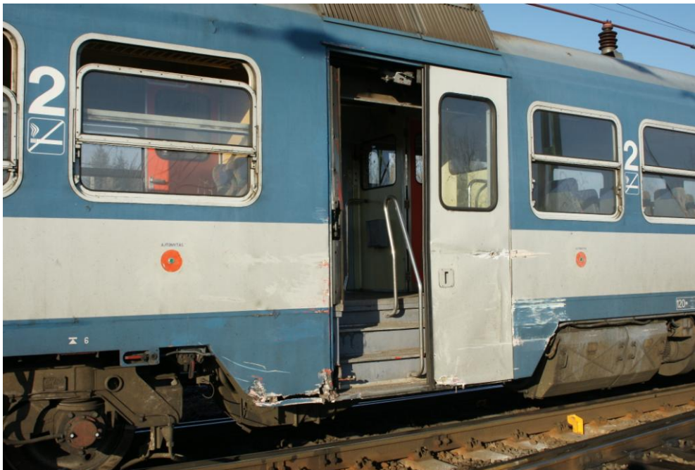
4.sz. ábra: az ütközés nyomai a BDV-011 vezérlőkocsin
