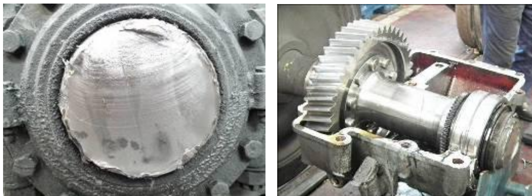
10. ábra: A fáradásos törés jele a tengelyen és a szétszerelt tengely-hajtómű
