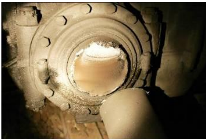
8. ábra: A törött tengely az eset helyszínén
