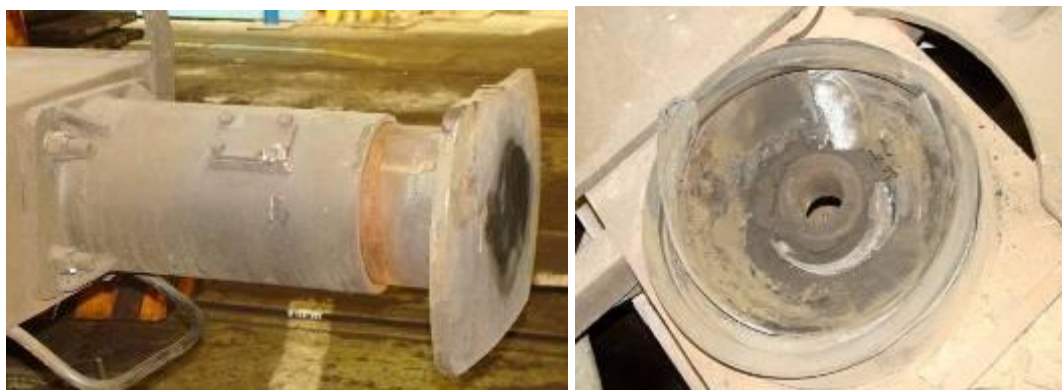
12. ábra: Kenetlen ütköző és a sérült forgótányér
