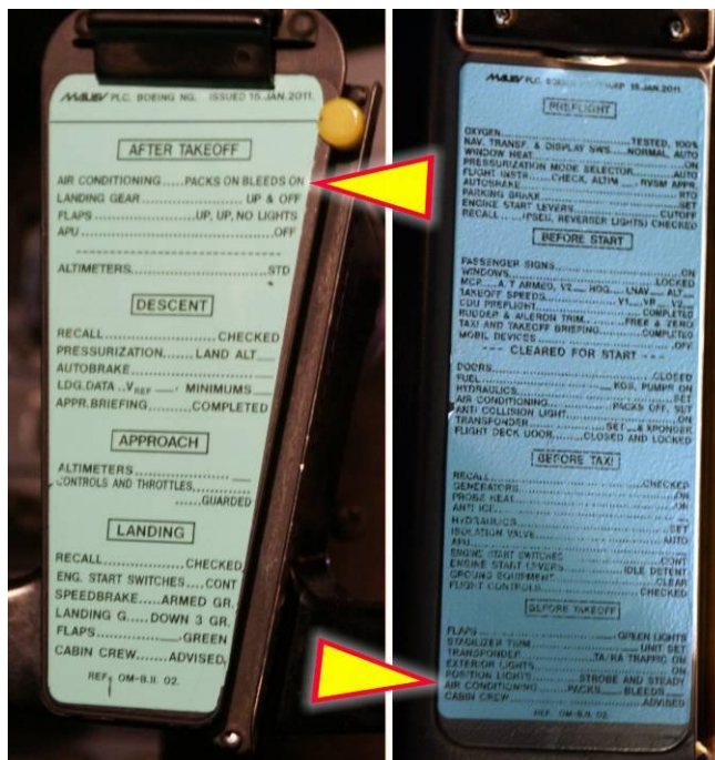
Pilótafülkében elhelyezett „normál” ellenőrző-listák (jelölve a felszállás utáni és előtti listákban a légkondicionálóra vonatkozó sor)
