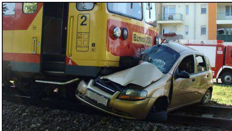
6. ábra: A személygépkocsi összeroncsolódott utastere
