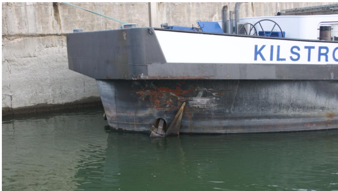
5. sz. ábra: A Kilstroom önjáró teherhajó sérülései
