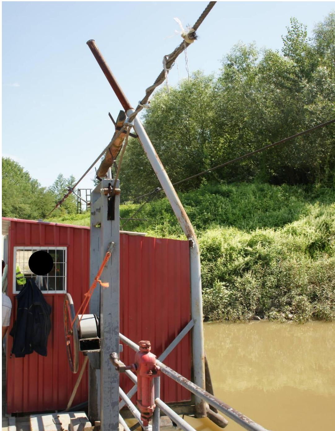
6. sz. ábra: A köteles komp elgörbült kótéltávtartó rúdja
