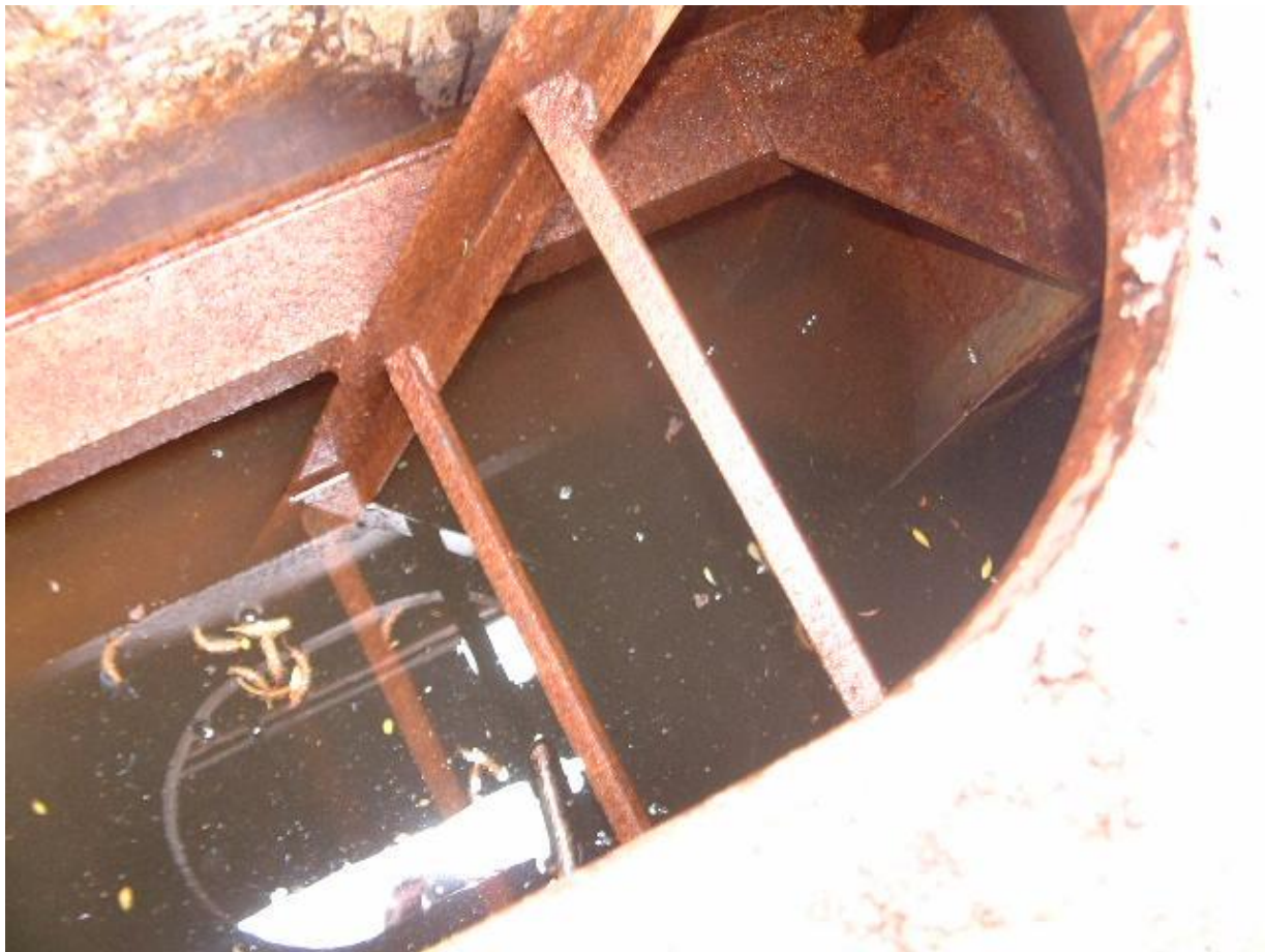
4. sz. kép: Az MHRT 1835-B bárka lékesedett kettős terében felgyülemlt víz
