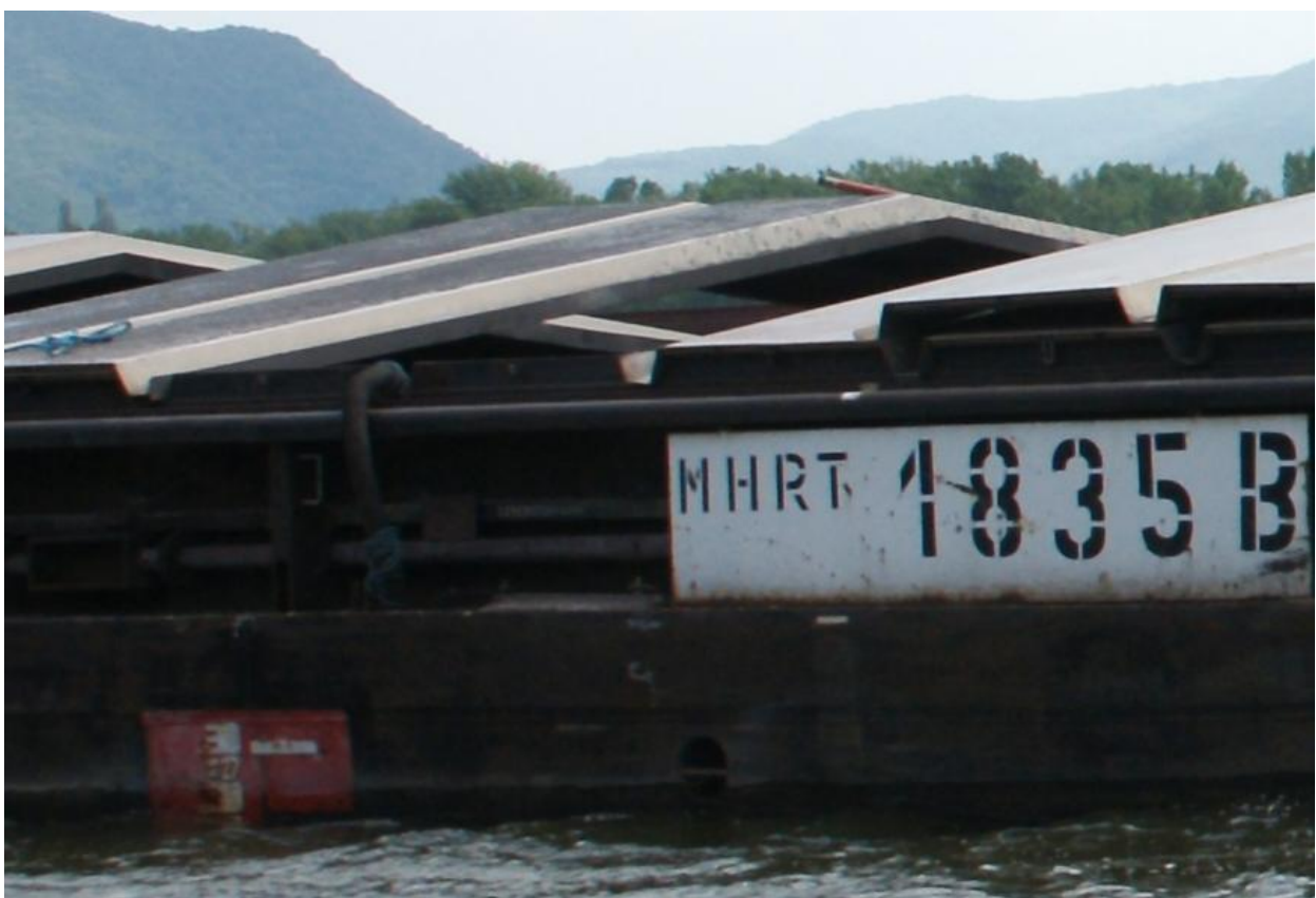
3. sz. kép: Az MHRT 1835-B bárka orr részén a merülése láthatóan 25 dm, pedig a rakjegyzék szerinti merülés 21,5 dm
