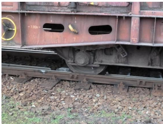
3. ábra A kitörött csúcssín darab és a kisiklott tengely
