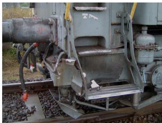
4. ábra: A mozdony sérülései (forrás: VBO.)
