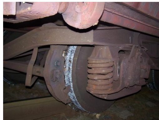
2. kép: Siklott forgóváz (forrás: VBO)
