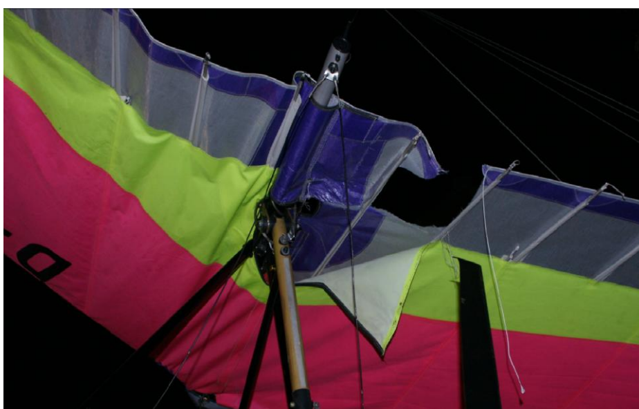
3. ábra: Vitorla a szárnygerinc melletti szakadással
