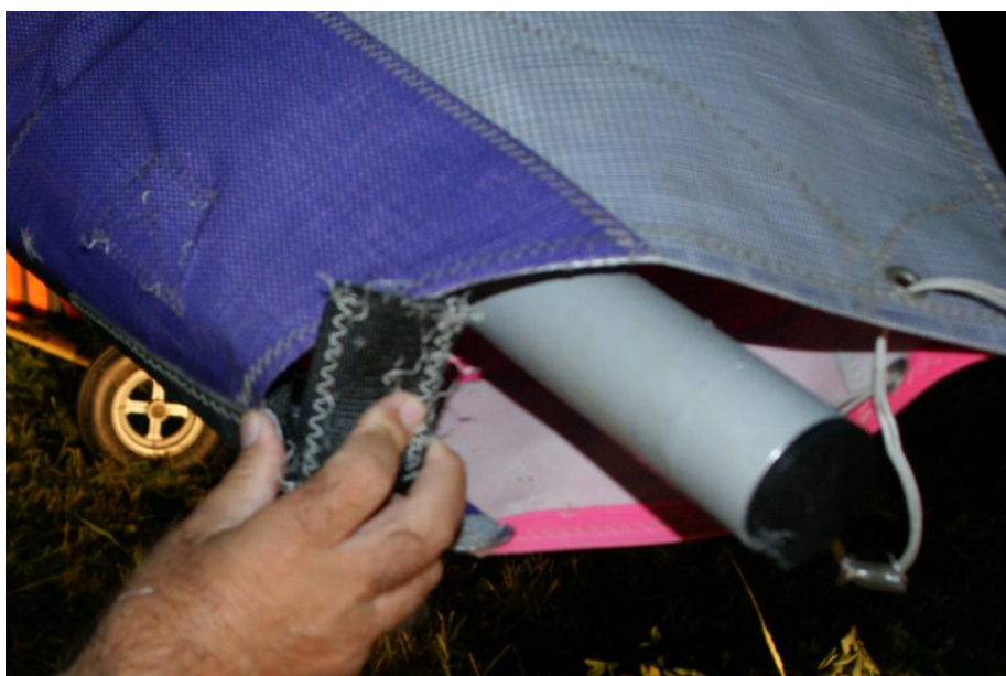
2. ábra: A bal félszárny leszakadt szárnyvég vitorlarögzítő hevedere
