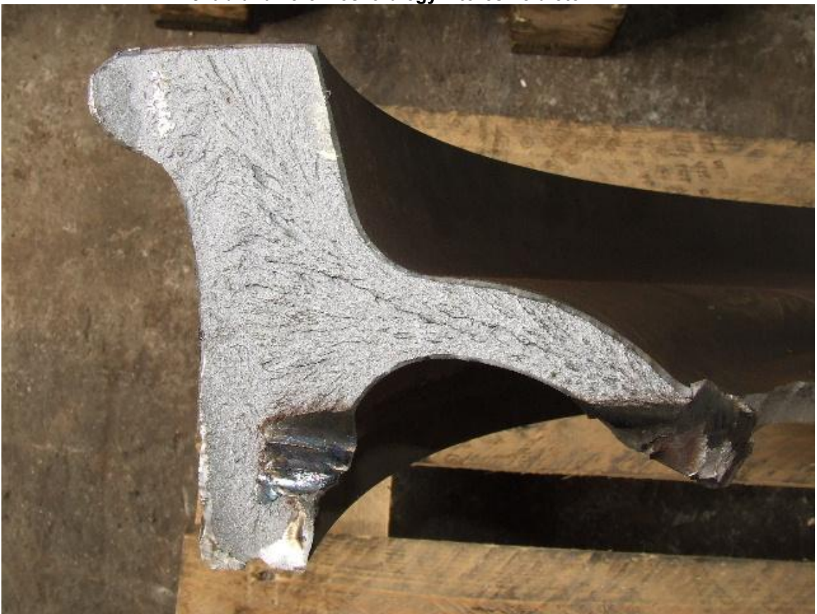
14. ábra: a kerékkoszorú másik törési felülete
