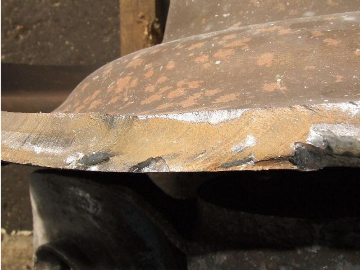
15. ábra: törési felület a keréktárcsán
