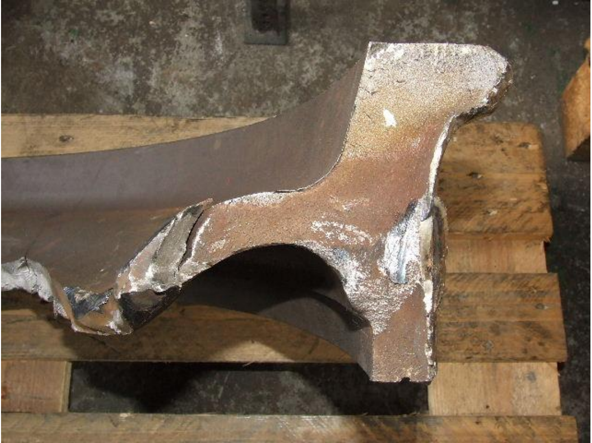
13. ábra: a kerékkoszorú egyik törési felülete
