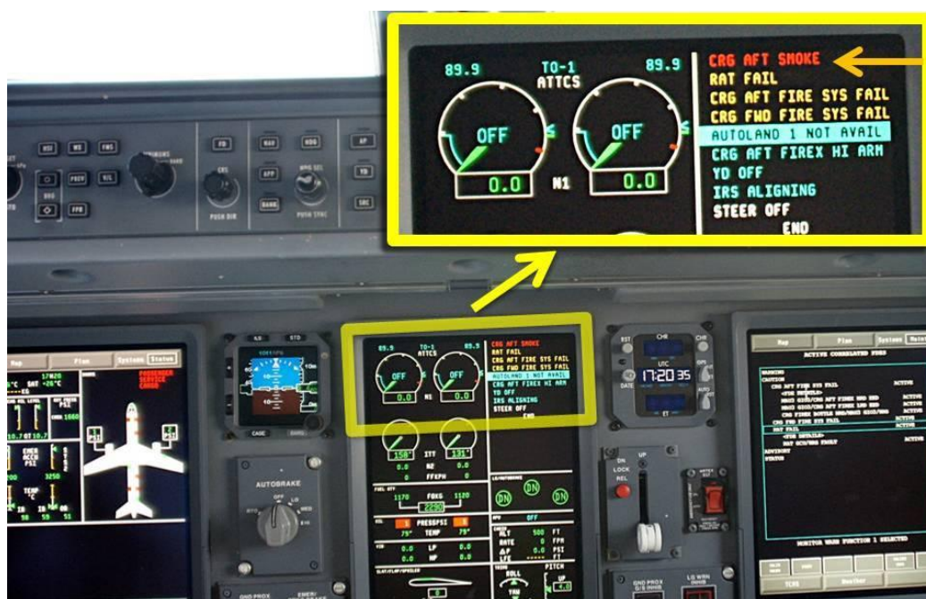
2. ábra Hátsó csomagtér füstjelzés megjelenése a pilótafülke középső képernyőjén
