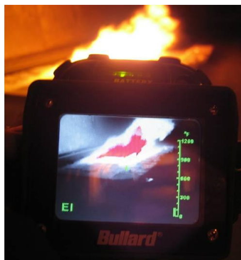
9. ábra A Repülőtéri Katasztrófavédelmi Igazgatóság által is használt „Bullard T4” hőkamera
