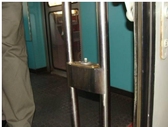
4. ábra A távzáró kapcsoló elhelyezése
