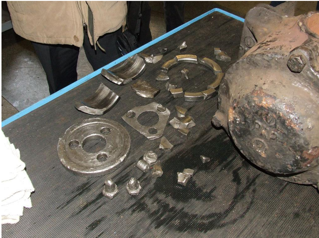
4. ábra: a csapágy kiesett és törött darabjai
