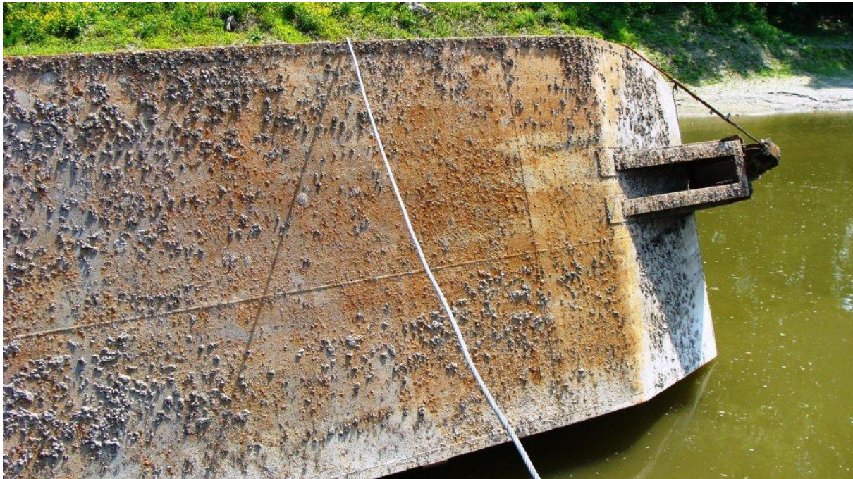
4. sz. melléklet: A süllyedt kotró fenékrésze a második megsejmlélés alkalmával. Sérülés, beszakadás, foltozás, benyomódás a kiálló részeken nem volt tapasztalható. A vedersor és a hajótest jobb oldala ezen a képen sem látható, még a víz alatt helyezkedik el.
