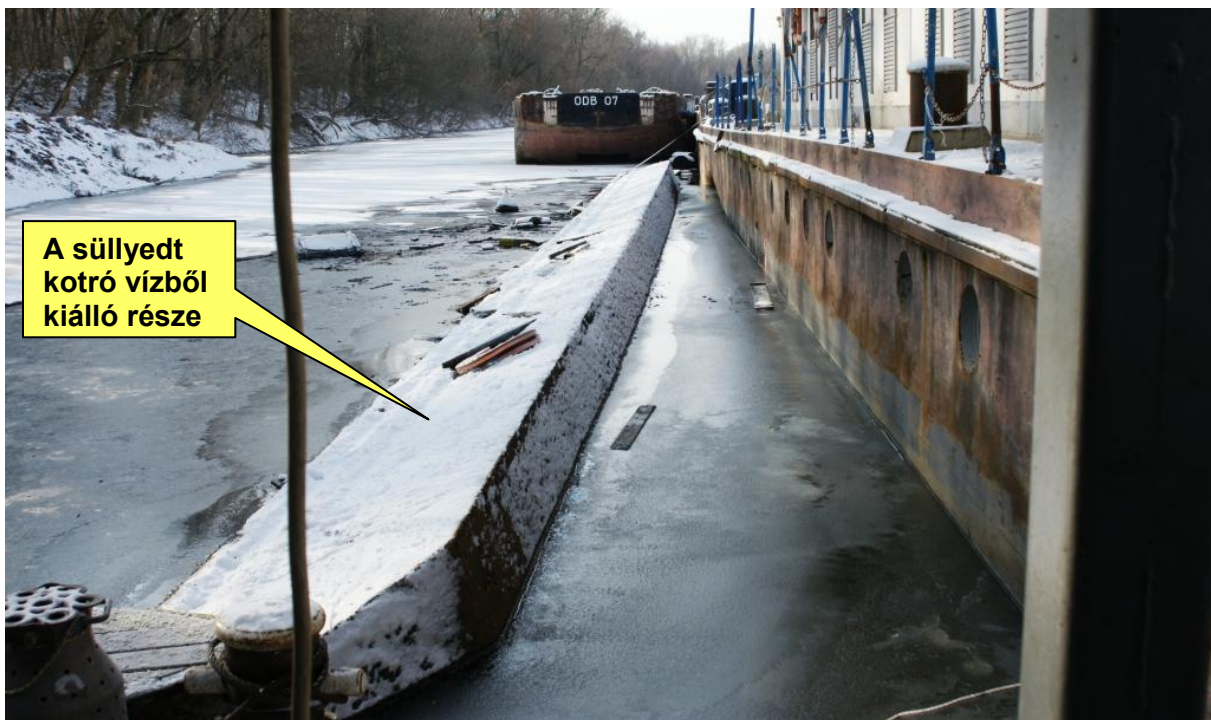
2. sz. melléklet: A süllyedt kotróból ennyi volt látható a helyszíni szemle alkalmával
