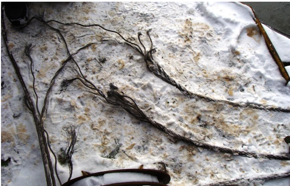
5. sz. melléklet: Egy szakadt összekötő kötélvég, mely a helyszíni szemle során készült
