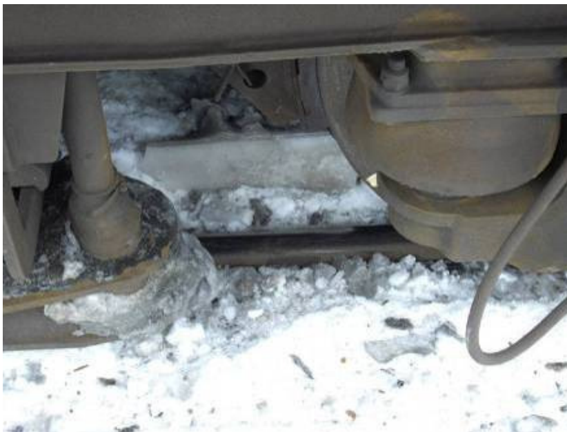
6. ábra: második siklási nyom
