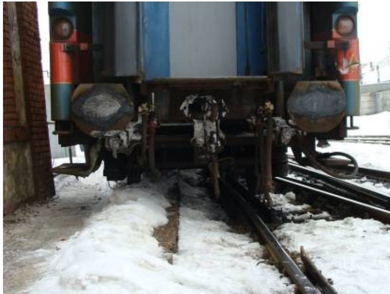
3. ábra: a kisiklott kocsi az állítóközpont fala mellett
