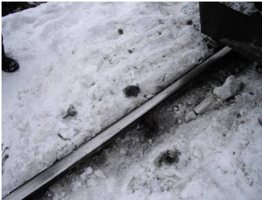
5. ábra: első siklási nyom
