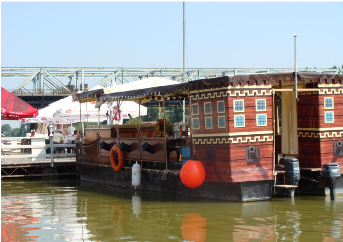
3. sz. melléklet: A szállodahajó pontonjához kikötött kiscgéphajó egy későbbi időpontban Kötélkorlát, védőháló ekkor sem látható a hajó bal oldalán hátul
