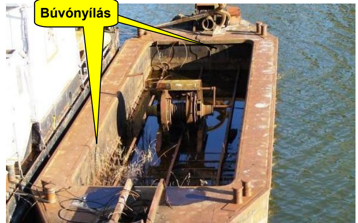
7. sz. ábra: A búvó nyílások elhelyezkedése
