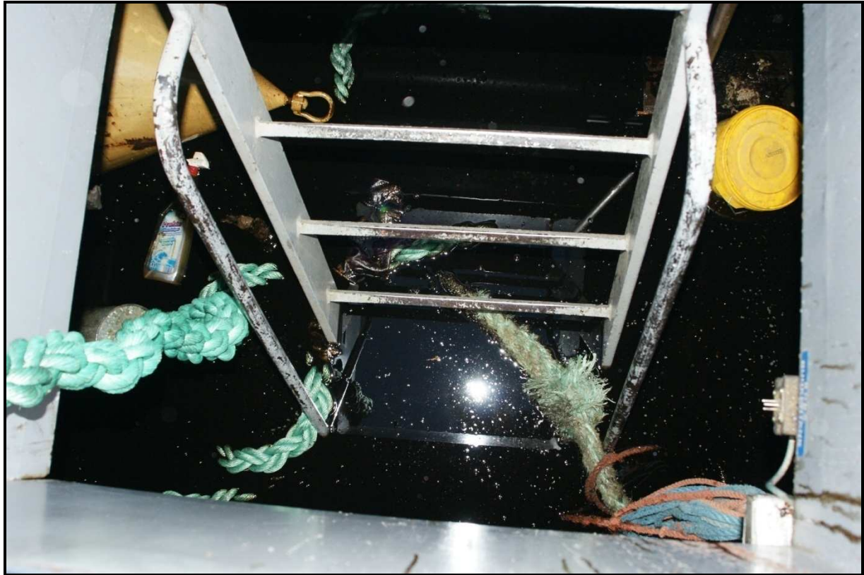
4.ábra A hajó orrában lévő segédgép térben olajos víz áll
