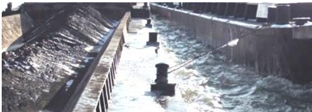
7. számú ábra az ANR 1430 bárka sérülése a kiszakadt kikötőbak
