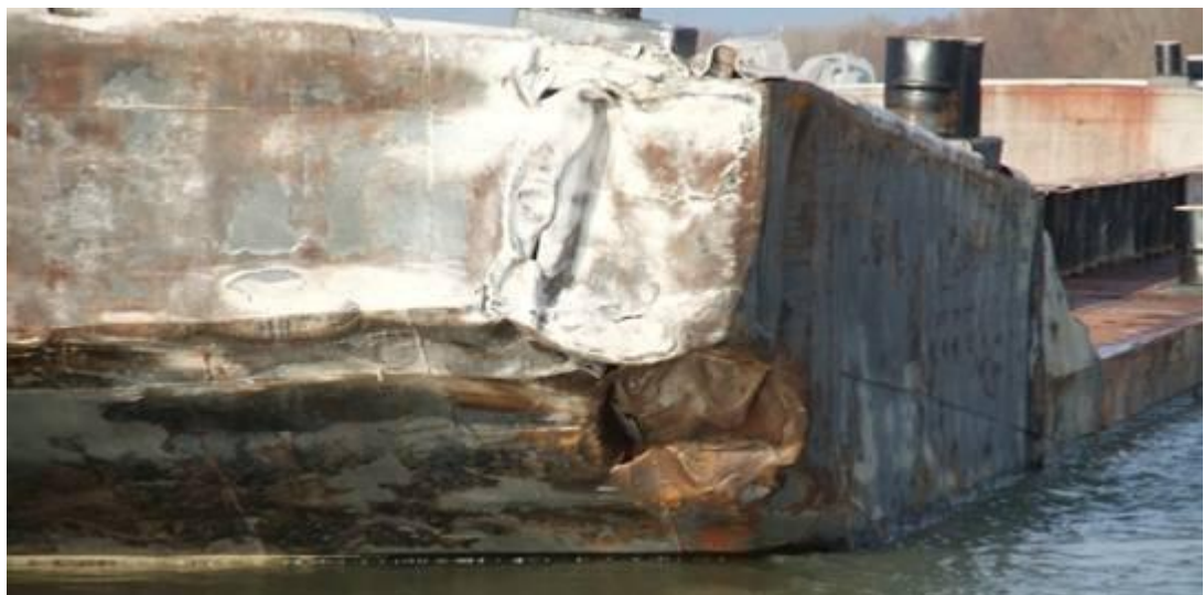
6. számú ábra az ANR 298 bárka hídpillérnek történő ütközés utáni sérülései
