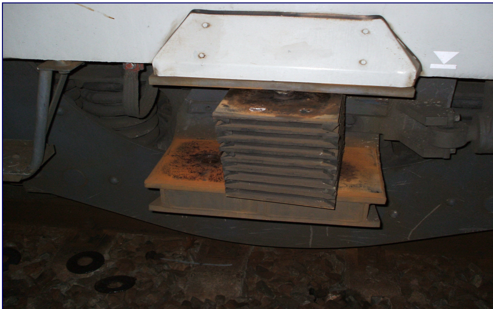
5. ábra: az elmozdult lengéscsillapító gumirugó
