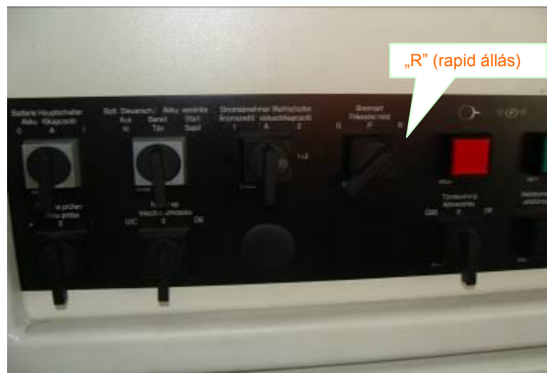
6. ábra: A legnagyobb fékhatást biztosító állás
