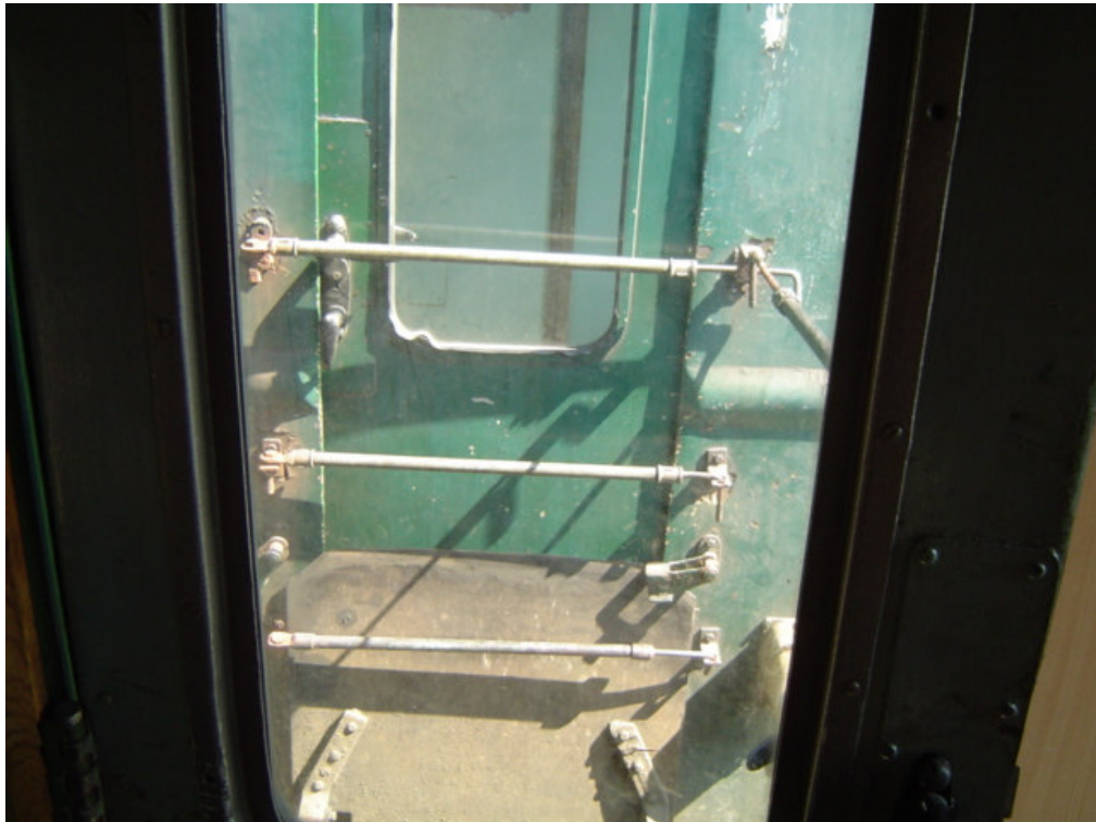
6. ábra: a részben szétkapcsolt átjáró a baleset után (fotó: MÁV Zrt.)
