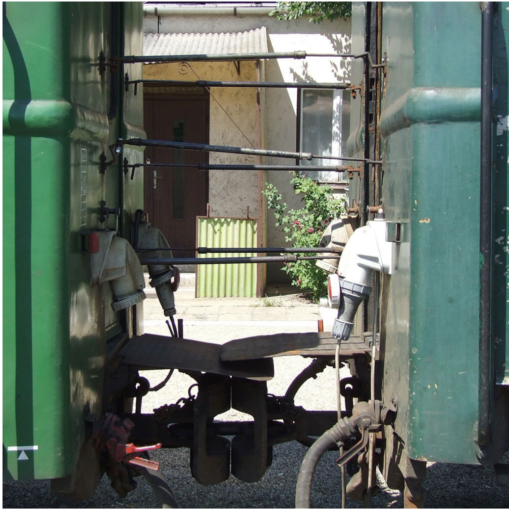
5. ábra: a kocsik átjáróhídjának szerkezete összekapcsolt állapotban
