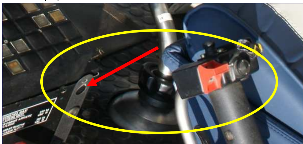
A helyszíni fotón a kollektív kar kioldott állapotban látható (a piros nyíl mutatja a rögzítés helyét).
