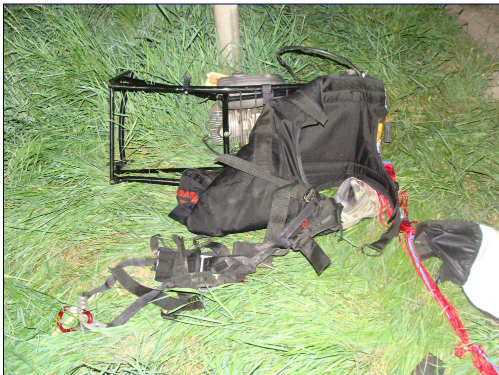
3. sz. kép: A hátimotor a szétvágott hevederzettel
