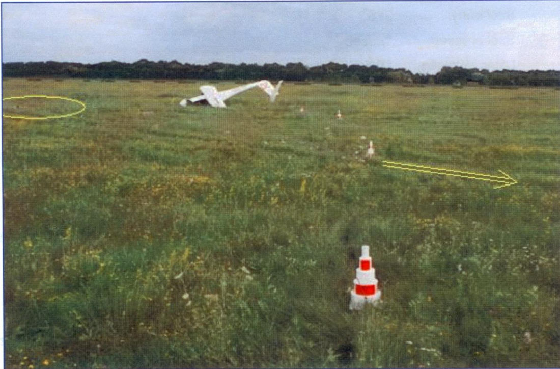
1. ábra: CIRRUS 75 VTC a kiszakadt jobb szárnyal és a kijelölt felszálló iránnyal
