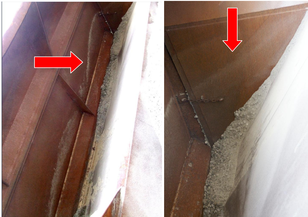
9. ábra: a rakomány szintjének nyomai a felborult kocsiban (a kép elforgatva)
