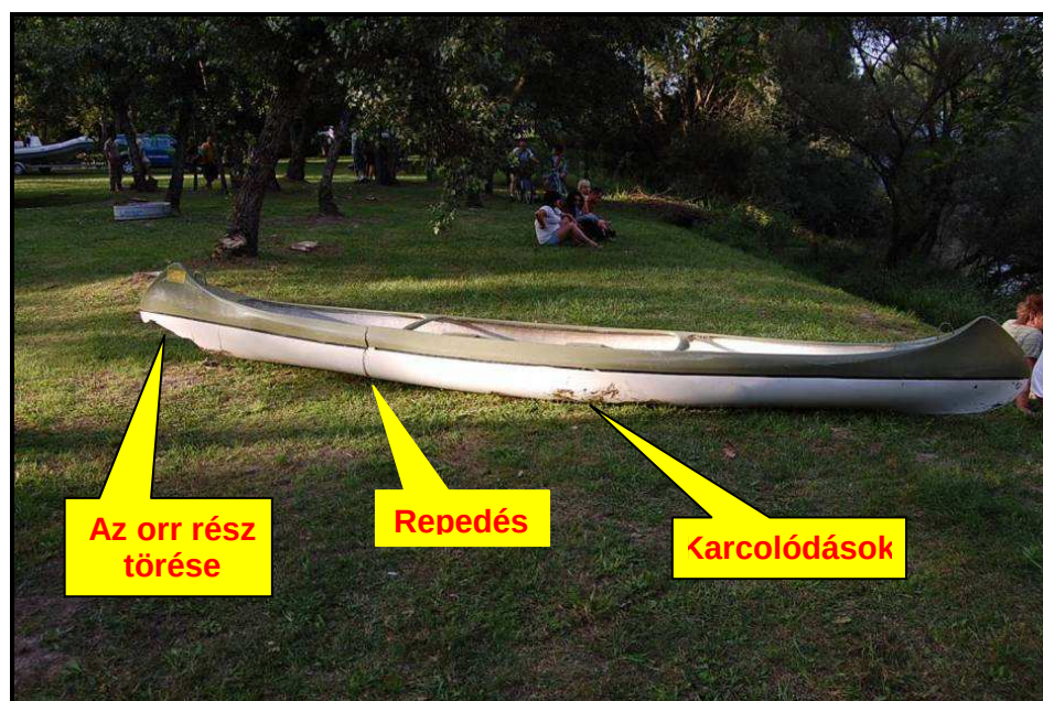
2. sz. ábra: A kiemelt túrakenu sérülései
