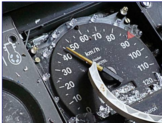
13. ábra: A motorkocsi kilométerórája az ütközést követően (Az ütközés sebessége a tönkrement műszeren is látszik)
