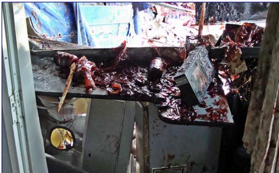
9. ábra: Összeroncsolódott vezetőállás
