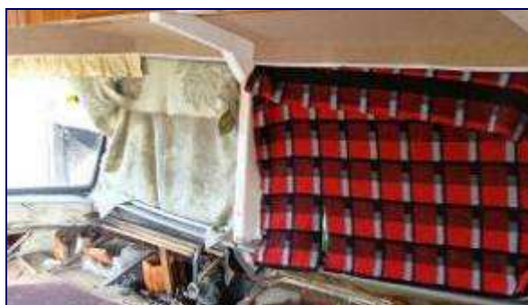
A megsérült burkolat és bordázat.
