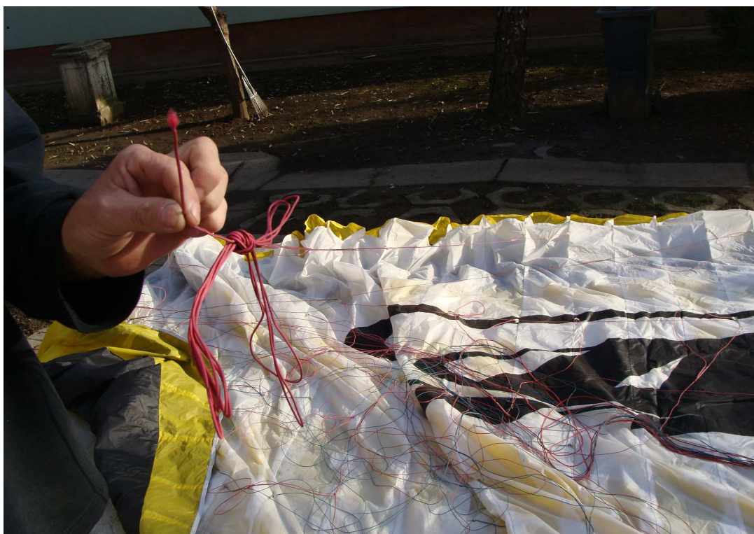
A tartószinór sérülése, amely a légi jármű akadályról történő leszedésekor keletkezett
