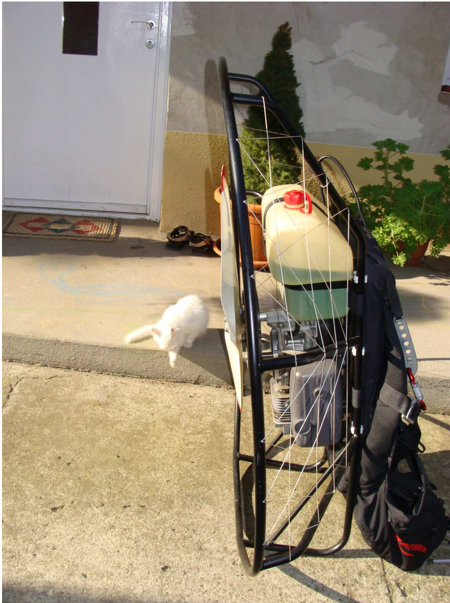
6. sz. ábra A légi jármű vezetőt védő kerete minimális deformitást szenvedett
