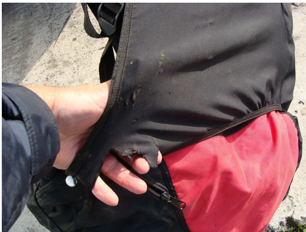
1. sz. ábra: A beülő sérülése, amely a légijármű vezető földet érésekor keletkezett
