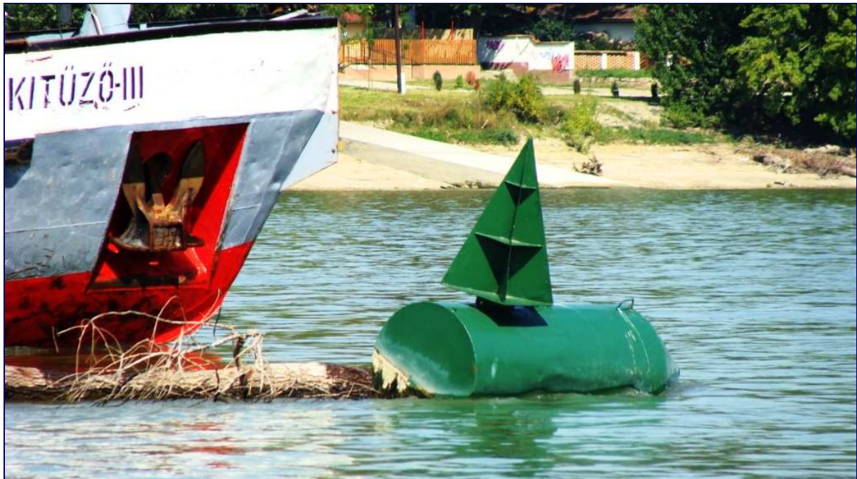
1. sz. ábra: A második helyszíni szemle alkalmával készített kép, amikor a kitűző hajó a zöld úszóról szabadít le egy uszadék fát
