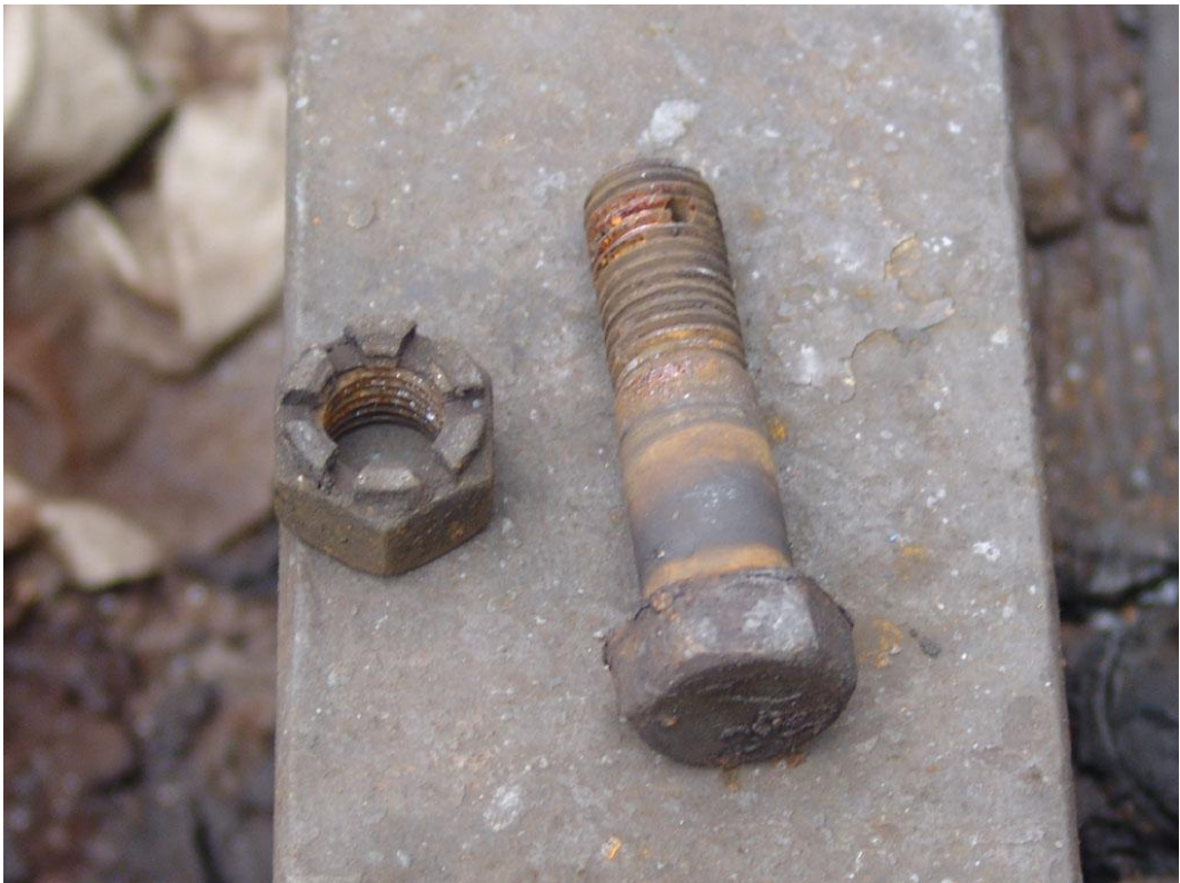
7. ábra: a kiesett csavar; mind az anyán, mind a csavaron látható a korróziós nyomokból, hogy hosszú időn át csupán 2-3 menet tartotta
