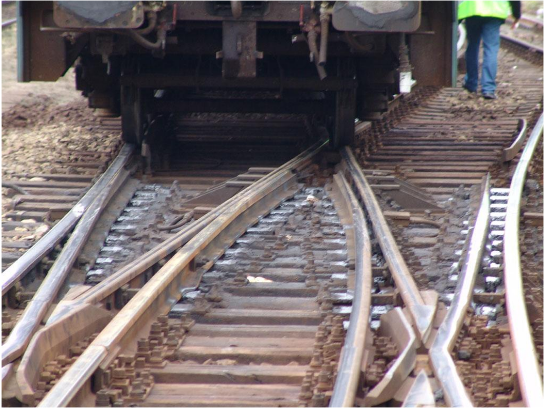
6. ábra: a kisiklást okozó csúcssín a baleset után; láthatók a sínszálakon a kisiklás nyomai is
