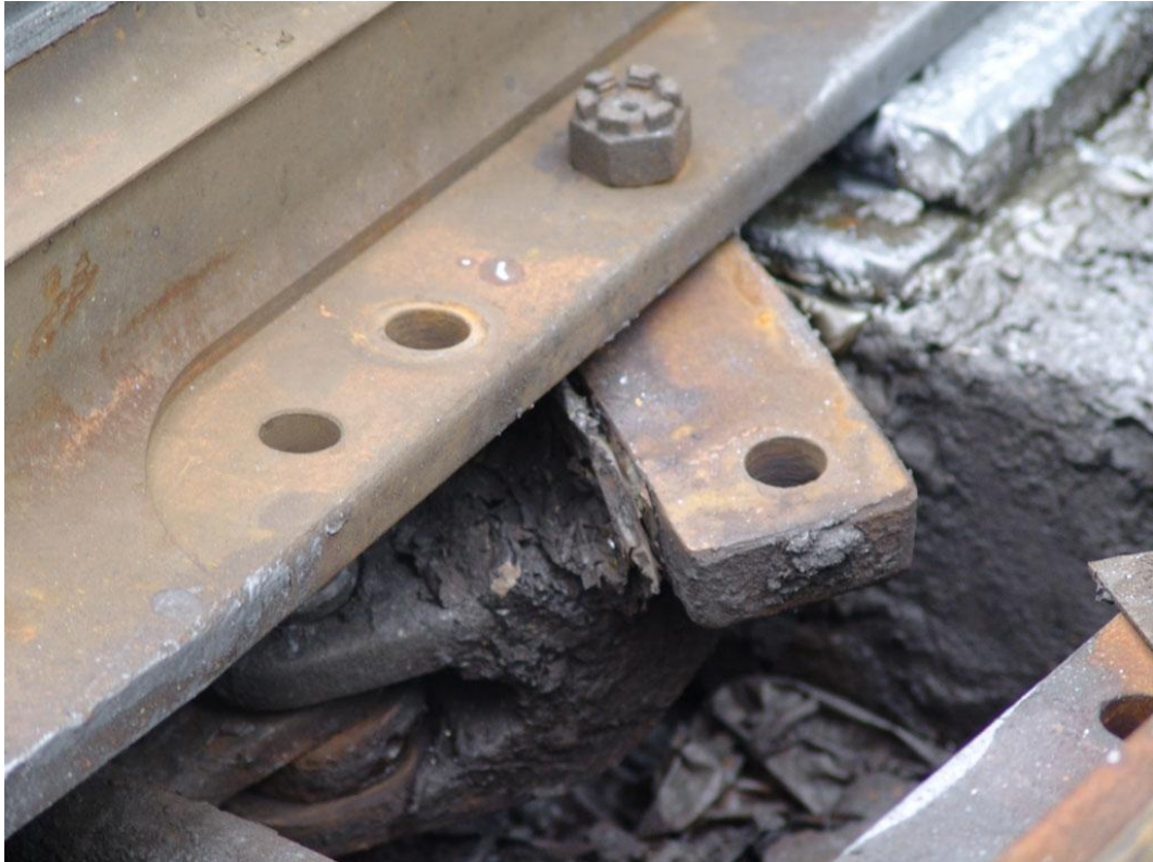
8. ábra: a szétesett csúcscsín-állítórúd kapcsolat: látható, hogy a helyén maradt csavar is laza
